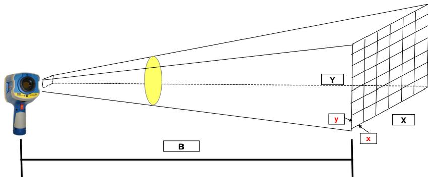
B - дистанция до измеряемого объекта, X- размер всего изображения по горизонтали, Y - размер всего изображения по вертикали, x - размер каждого одиночного пикселя по горизонтали, y - размер каждого одиночного пикселя по вертикали
